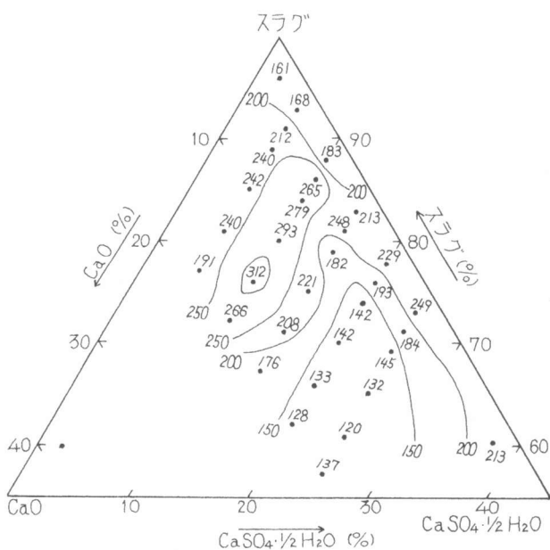
図2. 三成分図表における圧縮強度分布 (水中養生)
