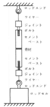
図1 付着強度試験方法
