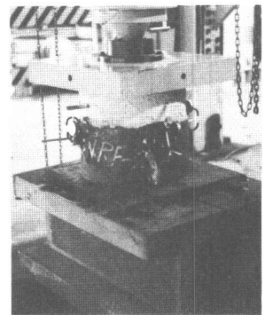
写真1 全充填形式縞鋼管の押抜きせん断疲労試験の状況
