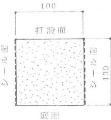
図 - 1 供試体断面図
