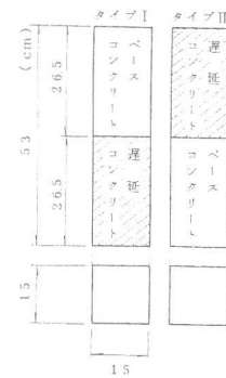
図-3 曲げ試験用供試体の打継ぎ方法
