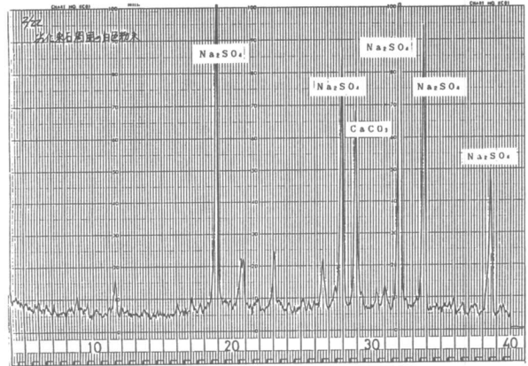
図-1 東石表面の白色粉末のX線回折結果
