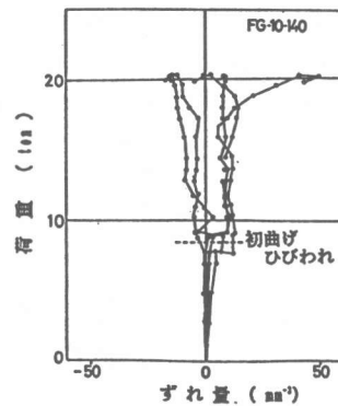
図-9 接着面のずれ変形
