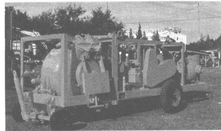
写真-1 吹付け機 (W1006×L3470 ×H1055mm)
