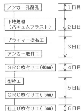
図-4 橋梁補修の施工工程
