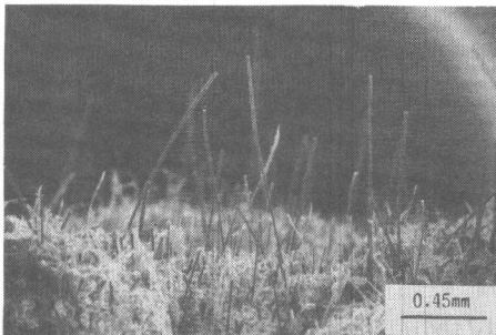
写真4 CFRCの曲げ破面 ( l_0=19\text{mm} , P=20\text{kg/cm}^2 )
