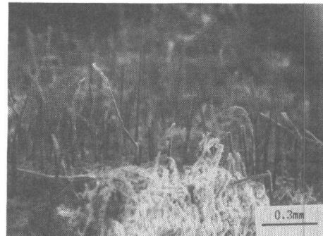
写真3 CFRCの曲げ破面 ( l_0=3.5\text{mm} , P=20\text{kg/cm}^2 )
