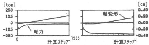
(a) 1階柱の軸力変動状況
