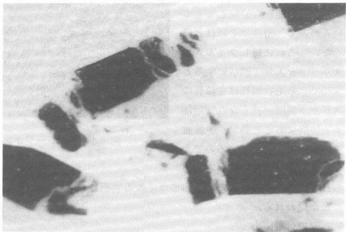
図-2 ポリプロピレン・セメント複合体の横断面 (N5)
