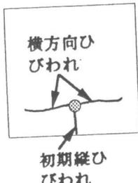
験では、縦ひびわれが発生しているにもかかわらず、腐食膨張効果による摩擦抵抗力の増加で極く初期の荷重時における滑りは生じていない（図-3）。しかし、この腐食膨張効果は、荷重の増加とともに失われ、鉄筋の自由端の滑りによる変位の増加が認められる。
