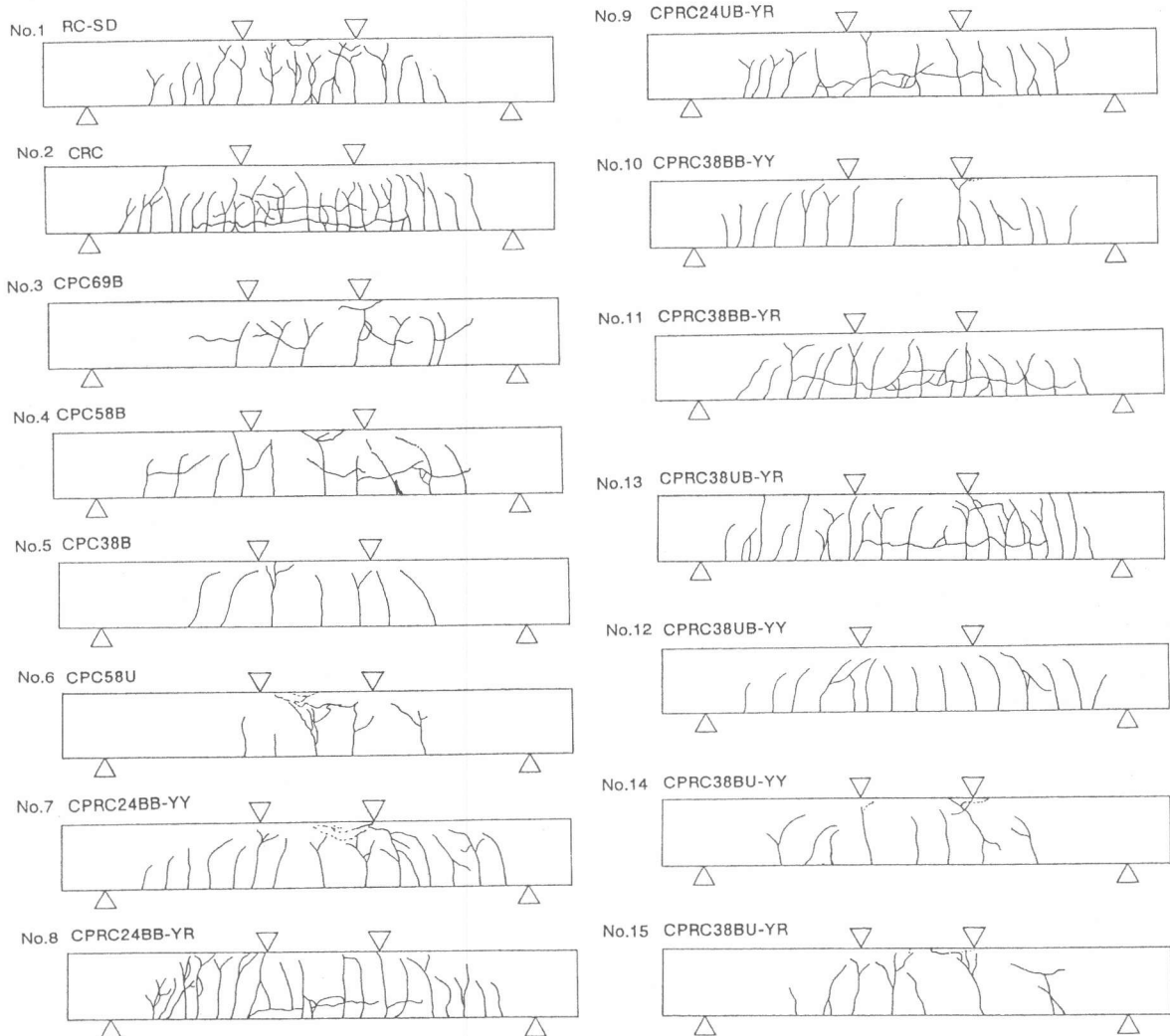
図-2 各試験体のひびわれ状況
