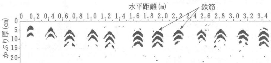
図-2 レーダー法による鉄筋ピッチおよびかぶり厚さの測定結果(導流壁)
