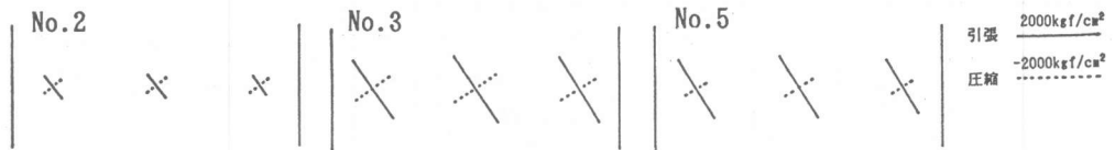
図-8 直交方向エンドプレートの主応力分布( R=1/100 )
