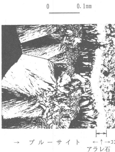
図-8 2倍濃度模擬海水浸漬供試体の光学顕微鏡写真 (Crossed polarized light)
