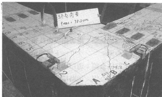
鋼板を上床版側まで伸ばした供試体 写真-1 隅角部ひびわれ状況
