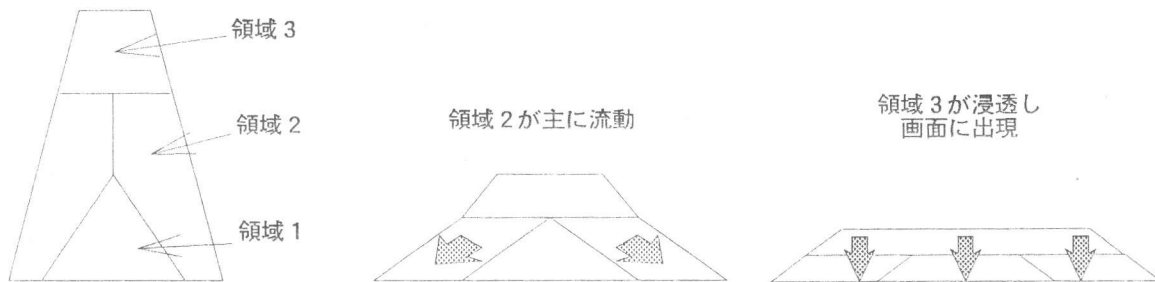
図-8 スランプ試験におけるコンクリートの挙動
