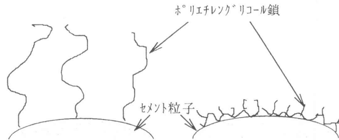
(a) ポリエーテル系分散剤 (b) ポリカルボン酸系分散剤
