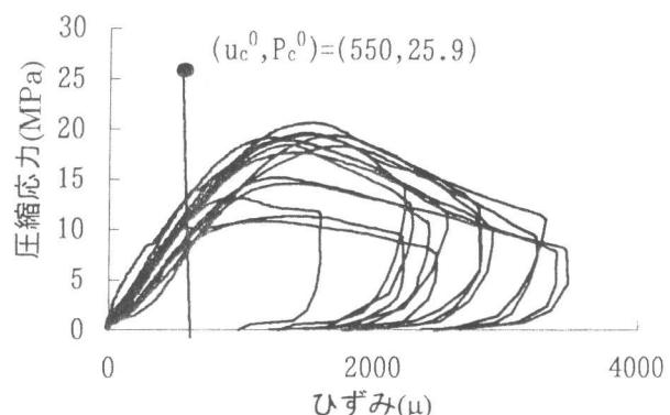
図3.応力ひずみ曲線(M:12mm)
