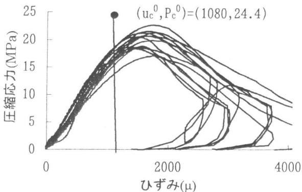
図2.応力ひずみ曲線(S:5mm)
