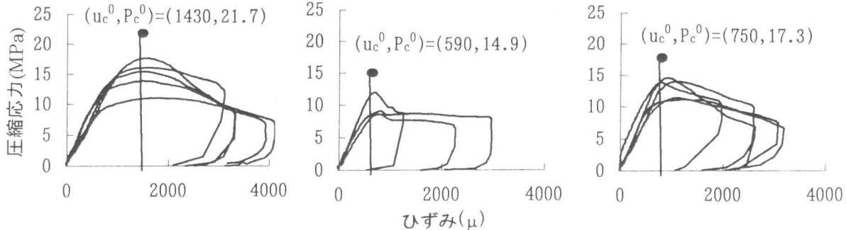
図8.応力ひずみ曲線のモードによる分類(L:25mm)
