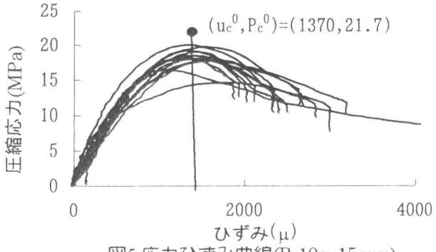
図5.応力ひずみ曲線(R:10～15mm)
