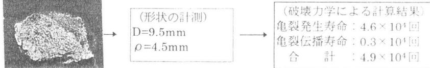
図-12 腐食した鉄筋の疲労寿命の比較
