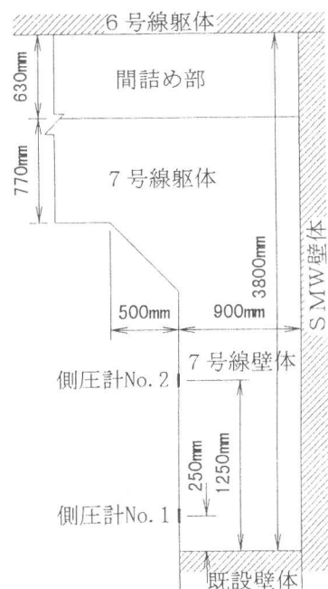
図-6 側圧計の設置位置
