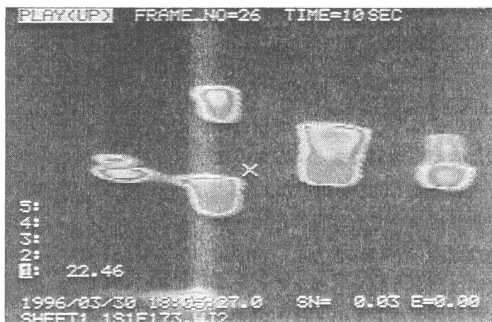
写真6 炭素繊維シート1層(区間変換処理画像)
