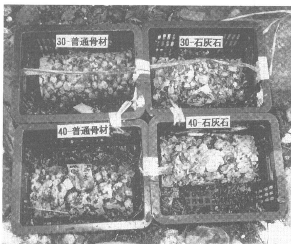
写真-1 No. 2地点ポーラスコンクリート状態
