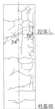
図-2 ひびわれ状況
