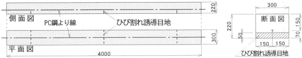
図-1 供試体形状寸法
