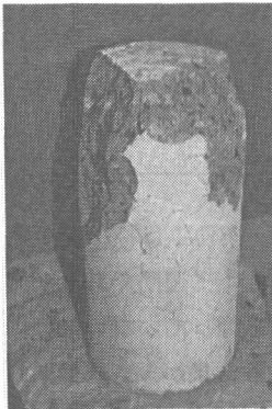
著しい爆裂あり
