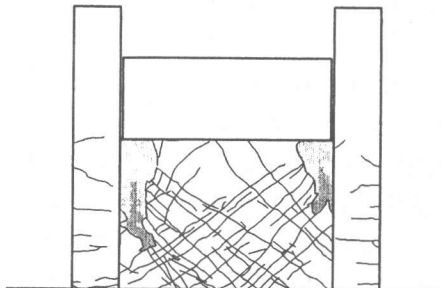
図-9 最終ひび割れ状況(97PCWE1)
