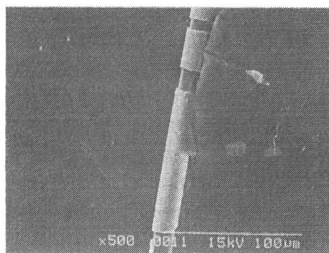
写真一七 ケブラーk49繊維のSEM (500倍) 観察 浸漬日数60日 (HCl溶液)
