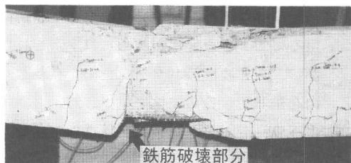
写真-1 試験体の破壊状況
