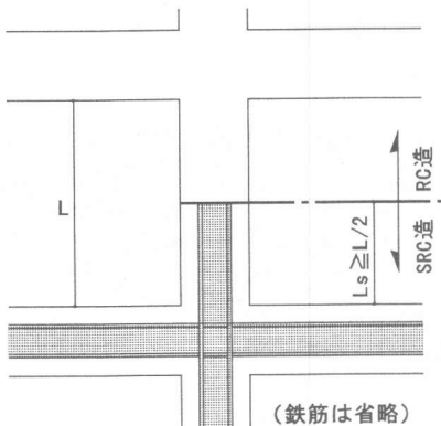
図-1 構造形式が切り替わる柱
