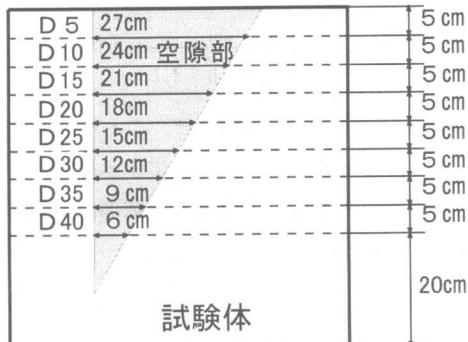
図5 試験体における検出精度解析位置
