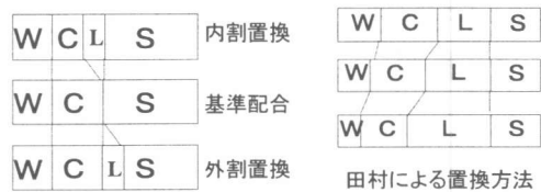
図-1 石灰石微粉末の置換方法
