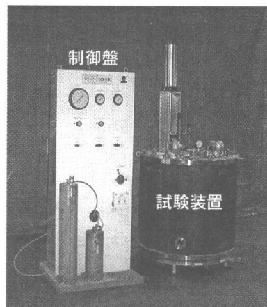
写真-1 高圧スランブフロー試験装置
