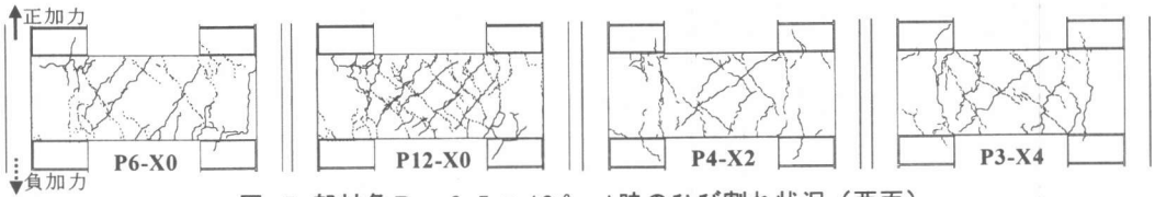
図-5 部材角 R = -0.5 \times 10^{-2} rad 時のひび割れ状況 (西面)
