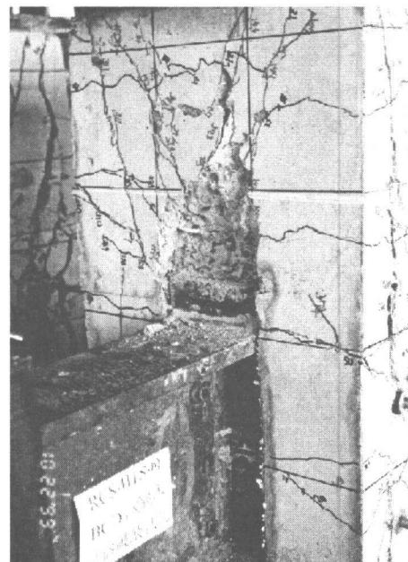
写真 - 1 BCD-1 試験体の E-FBP 周辺の破壊状況
