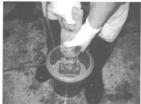
手順3：振動機を用いて振動を加える。
