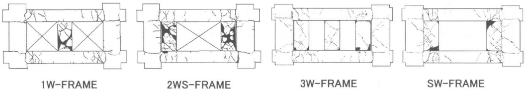
図-3 最終ひび割れ状況 (R=4%)
