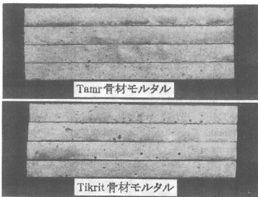
図-9 ASTM C 227のアルカリ反応状況 (供試体側面)
