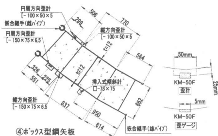
図-7 鋼矢板詳細断面図
