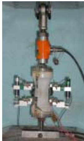
図-6 試験体設置状況
