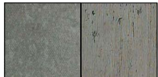
写真 - 1 透水性型枠 (左) と合板型枠 (右) を使用したコンクリートの表層
