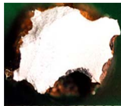
写真 - 5 疲労破断位置における 鉄筋断面形状(鉄筋 A)
