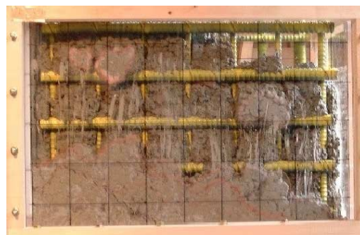
写真 - 2 充填状況 (実験 NO.1, 面 B - 配筋 H32V19)
