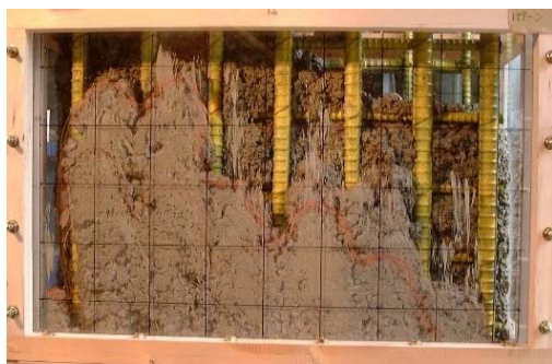
写真 - 1 充填状況 (実験 NO.1, 面 A - 配筋 V32H19)
