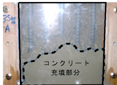
写真 - 2 充填状況 (アクリル面)
