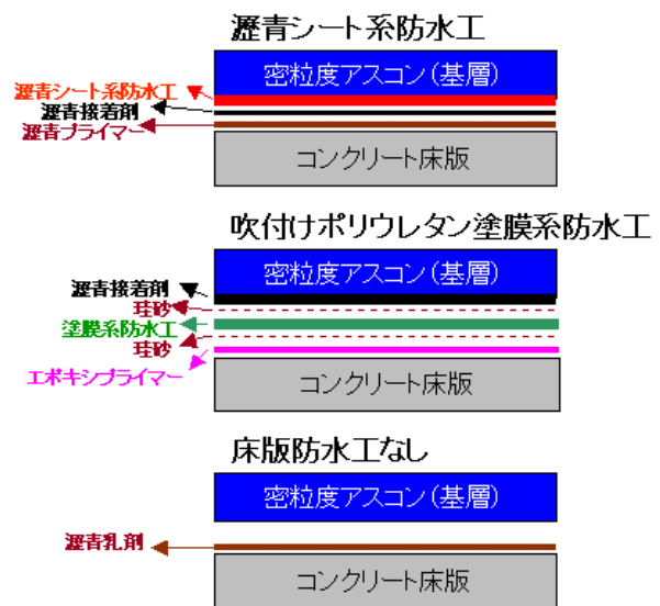
図-2 供試体の層構成
