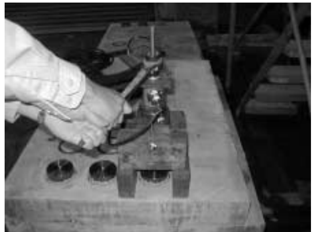
写真 - 7 付着強度試験載荷状況
