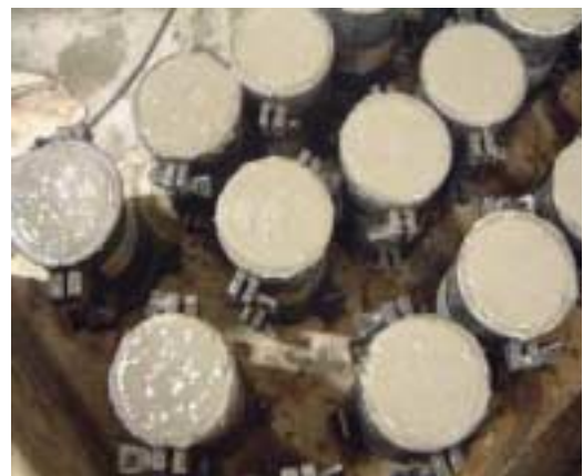
写真-3 加振終了後のコンクリート状態
