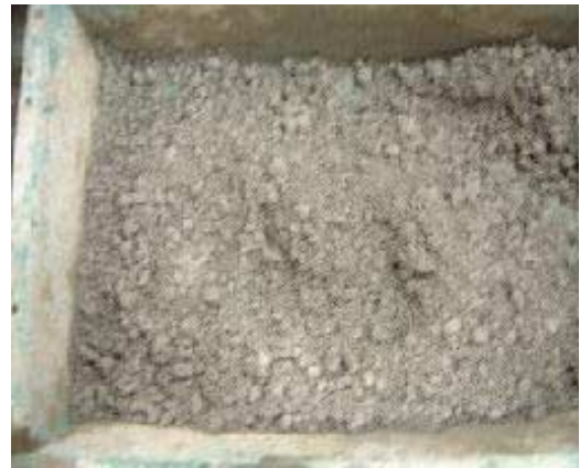
写真-2 練混ぜ直後のコンクリート
