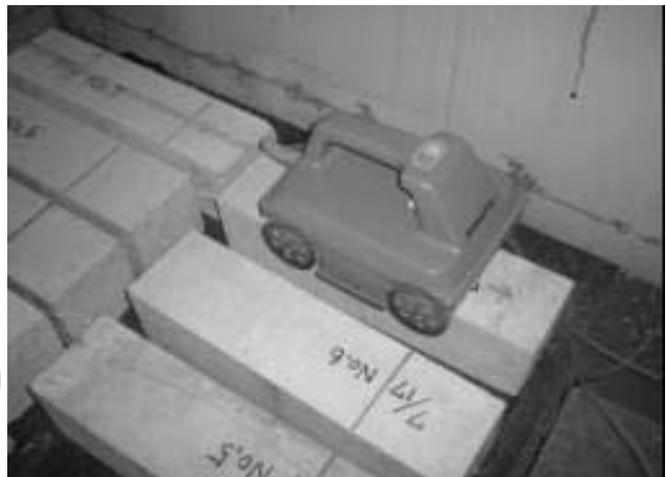
写真 - 1 電磁波測定状況
