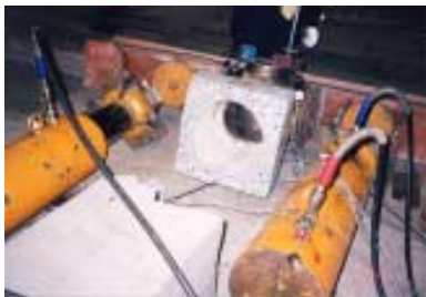
写真-2 引張実験の破壊状況
